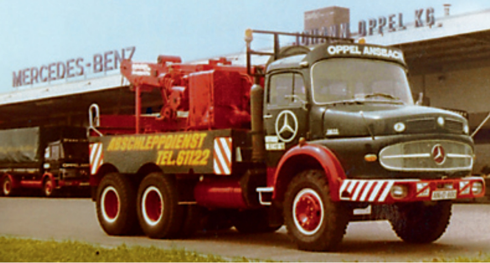
Auch der gehörte dazu: Abschleppwagen LK 2633 mit 6x4-Antrieb. Das 230 PS starke Auto verfügt über 13.750 ccm Hubraum und verkräftet ein zulässiges Gesamtgewicht von 26 Tonnen
